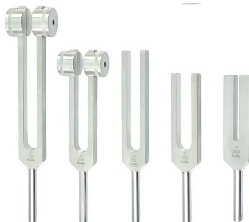
Рис. 4. Набор камертонов для определения остроты и объема слуха
